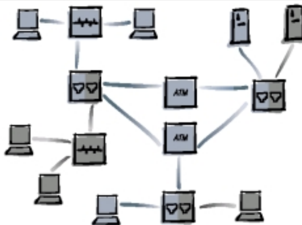
Рисунок 1. VLAN как группа коммутируемых портов
